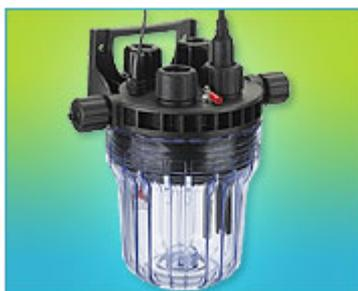
In einer Messkammer mit einem integriertem Strömungswächter, können bis zu vier weitere Sensoren über eine einfache Verschraubung wasserdicht in einen Messwasserkreislauf eingebracht werden. Dabei sorgt die Konstruktion der Messkammer für eine **optimale Anströmung** mit einem **Selbstreinigungseffekt** für die verschiedenen Sensoren.
